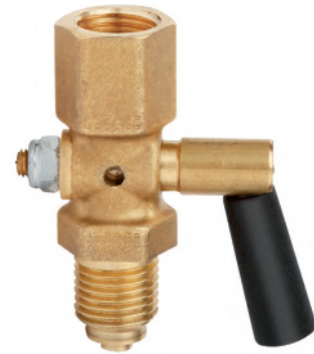
截止阀 内螺纹/外螺纹G 1/2 / G 1/2 B，符合DIN 16261标准，PN 25
